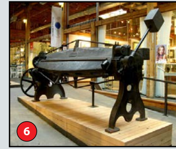
24 allée Tank House Plieuse manuelle de tôles
